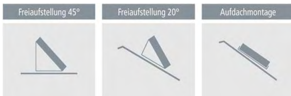
Abb. 87: Möglichkeiten der Kollektormontage, [Quelle: http://www.westfa.de ]
